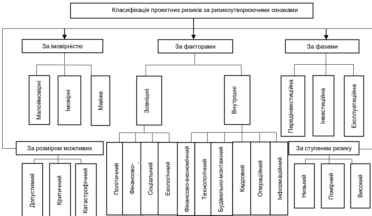
Рисунок 2 – Класифікація проектних ризиків за ризикоутворюючими ознаками в будівельній галузі Джерело: складено авторами
